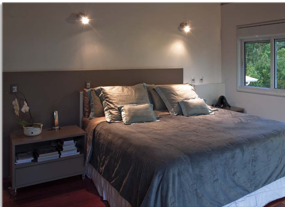
No quarto do casal, dois projetores dimerizáveis sobre a cama com lâmpadas PAR 20 criam ambiente para leitura.
